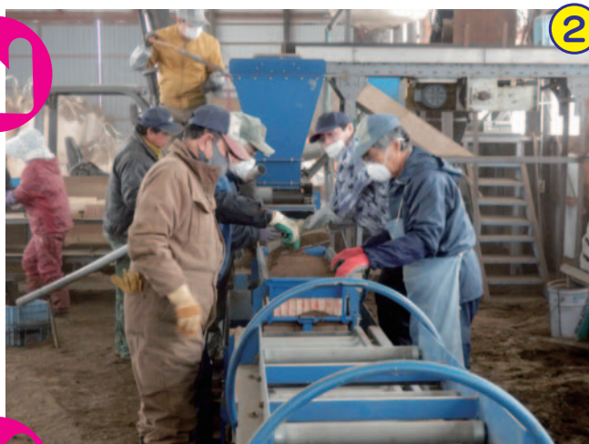
①で広げたポットに機械で土を入れ、均した後、受け皿に載せます。
